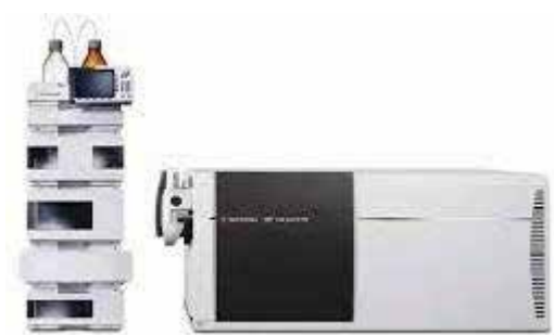
Figura 3: LC-ESI-MSMS utilizado para el desarrollo del método analítico Excell de 2APY, EHP y ATHP.
